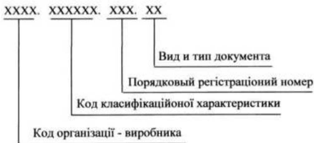
Рисунок 1.6 – Структура позначення конструкторського документа
