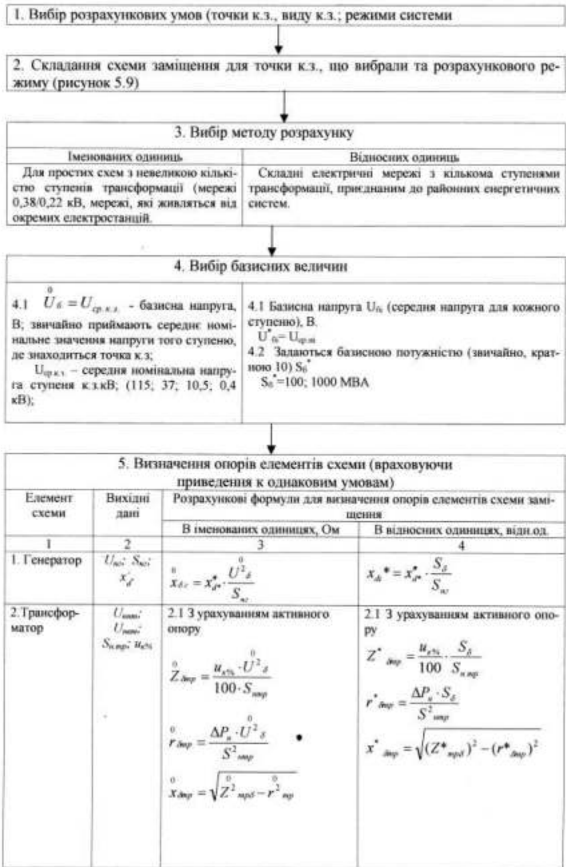
Рисунок 5.10.1 – Алгоритм розрахунку струмів к. з. у мережах напругою вище 1000 В
