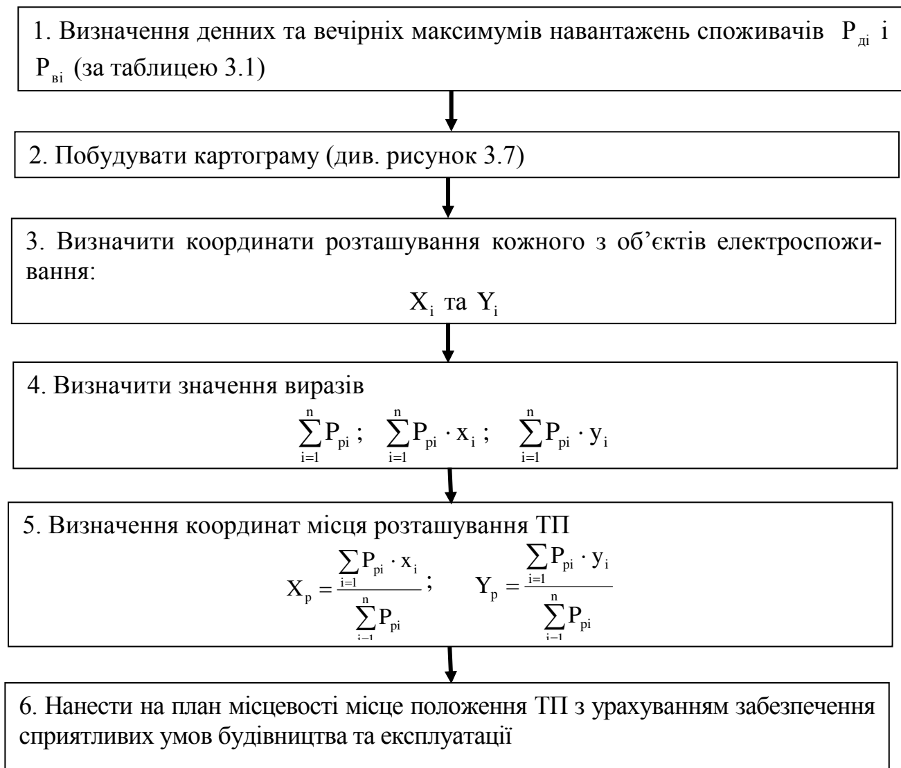
Рисунок 3.8 - Алгоритм визначення та вибору місця положення ТП
