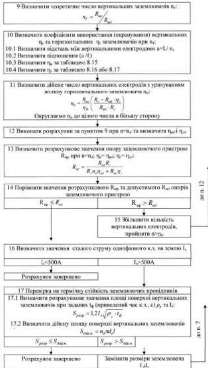
Рисунок 8.12.2 – Продовження алгоритму розрахунку заземлюючого пристрою
