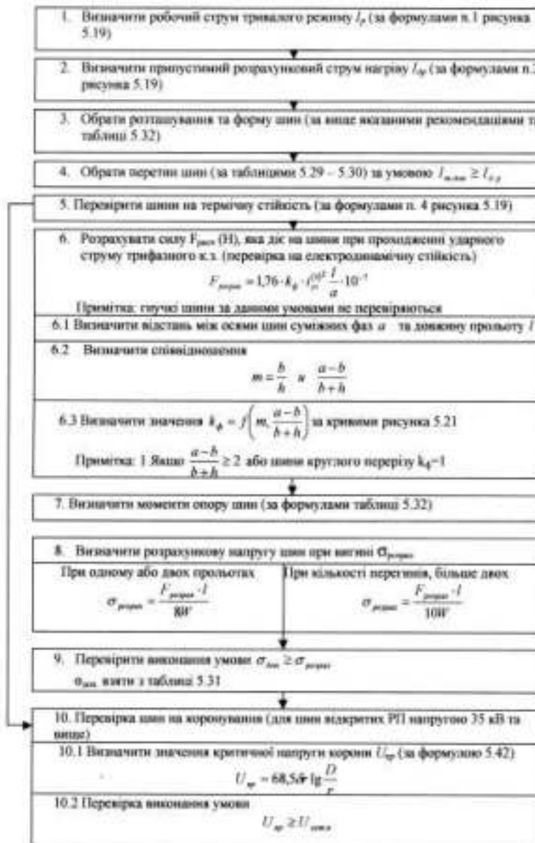
Рисунок 5.22 – Алгоритм вибору і перевірки шин
