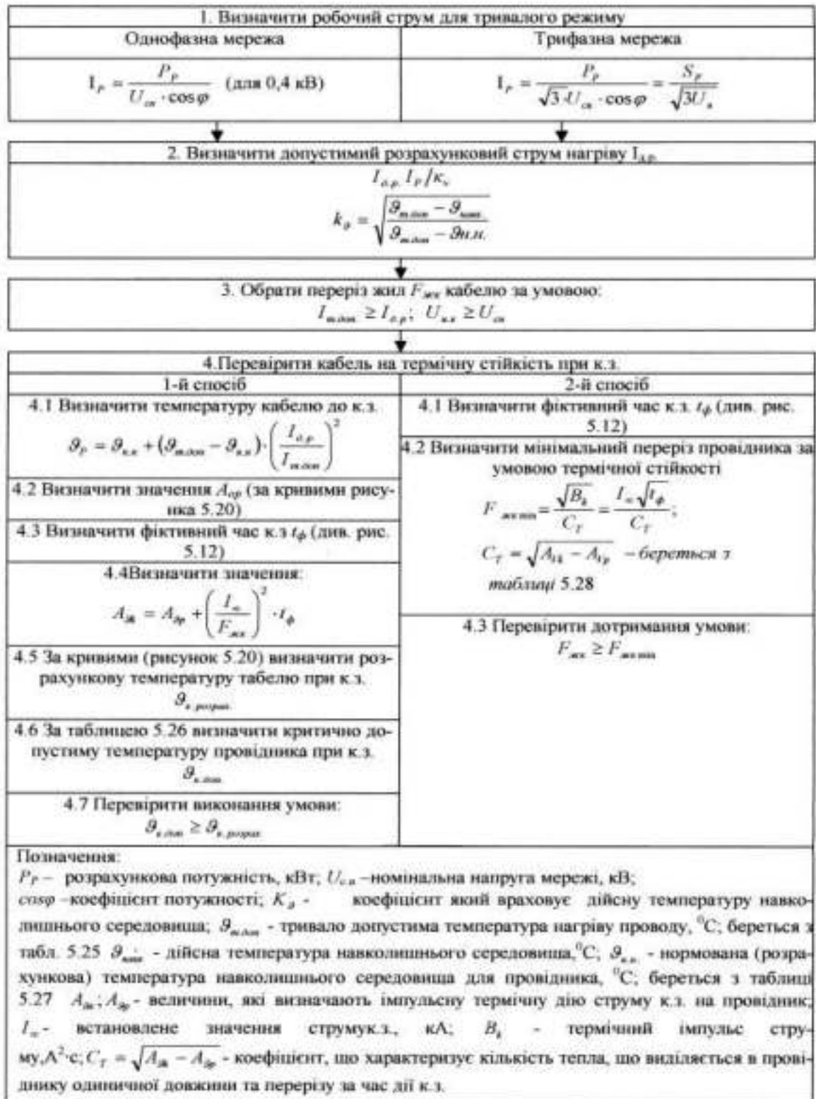
Рисунок 5.19 – Алгоритм вибору та перевірки провідників та кабелів
