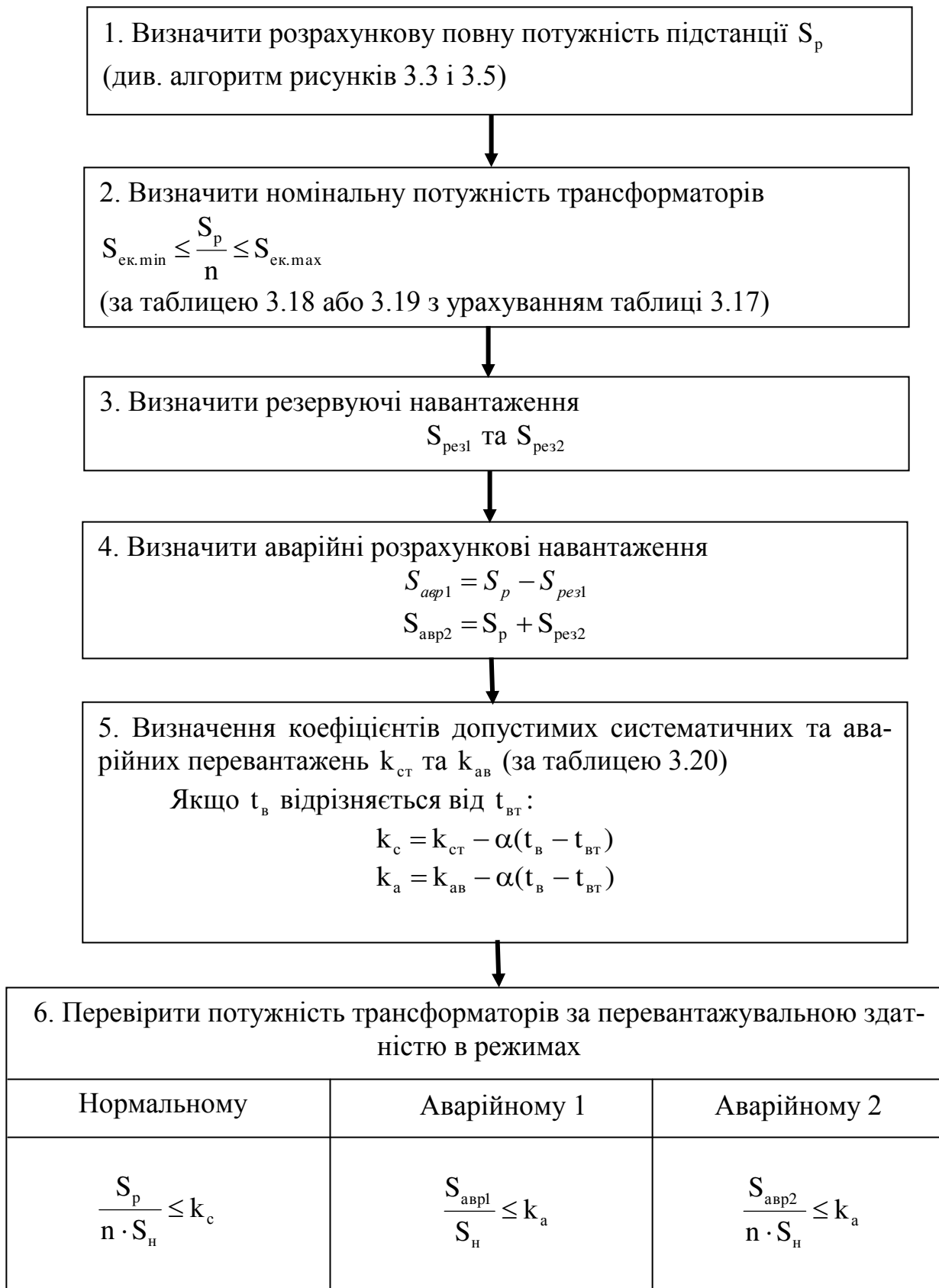
Рисунок 3.9 - Алгоритм вибору числа та потужності силових трансформаторів
