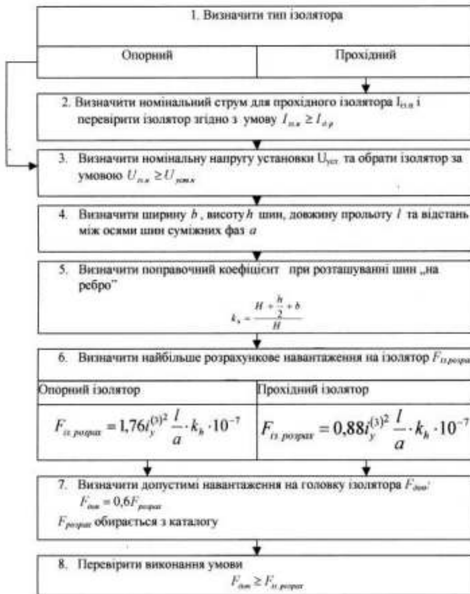
Рисунок 5.24 – Алгоритм вибору та перевірки ізолятора
