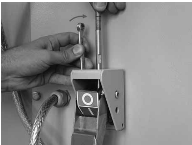
Рисунок 8.22 – Настроювання положення елементів вузла індикації та аварійного відключення
