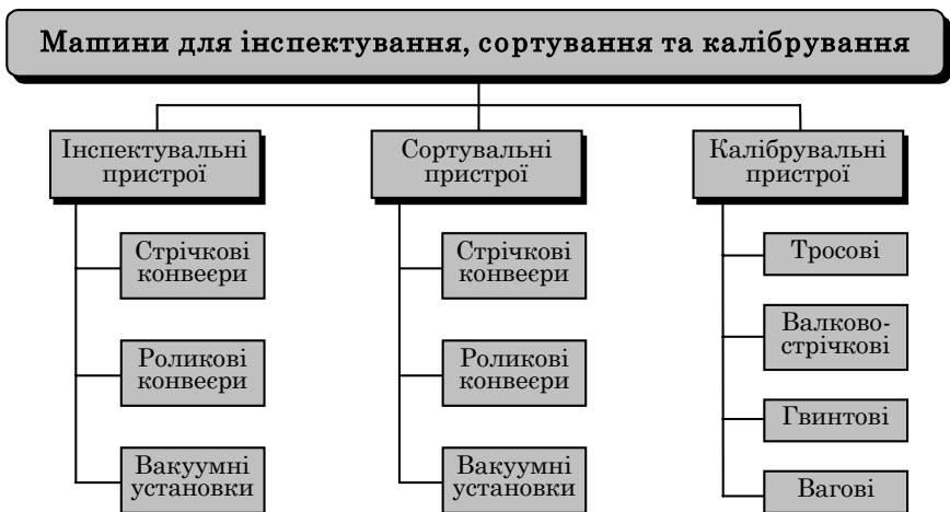
Рис. 1.23. Класифікація машин для інспектування, сортування та калібрування плодоовочевої сировини
