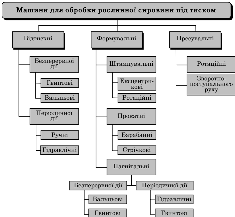
Рис. 1.69. Машини для обробки рослинної сировини під тиском
