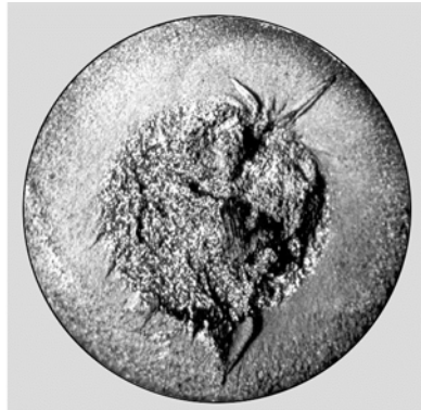
Рис. 2.10. Волокниста будова макроструктури поковки півосі автомобіля
