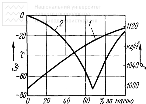
Рис. 9.1. Графік низькозамерзаючих сумішей води і етиленгліколю: 1 - крива густини; 2 - крива температури кристалізації
