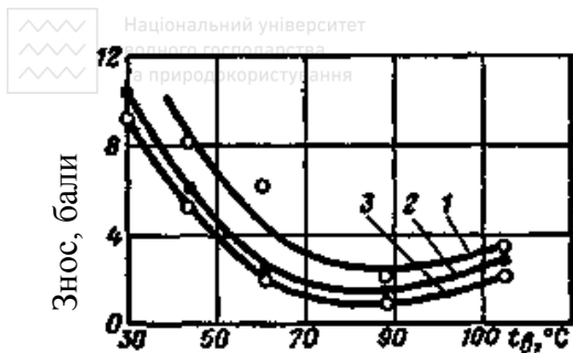
Рис. 5.4. Вплив температурного режиму двигуна на знос компресійних поршневих кілець (стендові умови, n=1500 об/хв) 1, 2, 3—перше, друге і третє кільця
