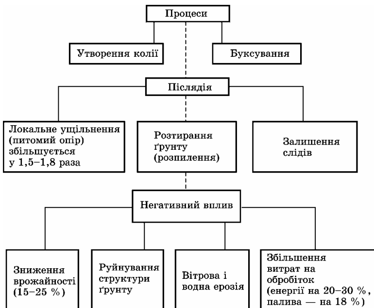
Рис. 19. Схематичне зображення шкідливої дії ходових систем сільськогосподарських машин на ґрунт
