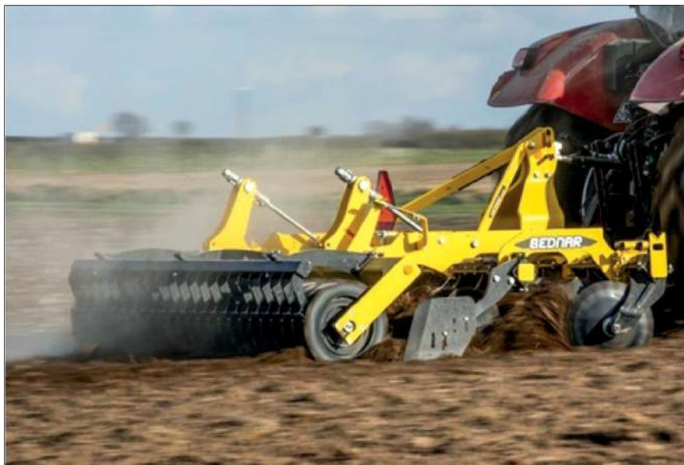
Рис. 8.10. Дискова борона SWIFTERDISC XN
