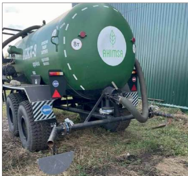
Рис. 9.26. Бочка для внесення рідких добрив у рядок ягідних культур. Фото Ю. Танцюри
