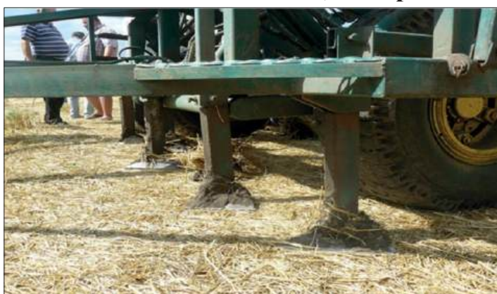
Рис. 9.62. Висівний сошник сівалки власного виробництва фермера О. Дона. Фото М. Бикова, 2017 р.
