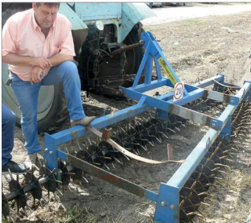
Рис. 9.64. Роторна борона. Фото М. Бикова, 2017 р.
