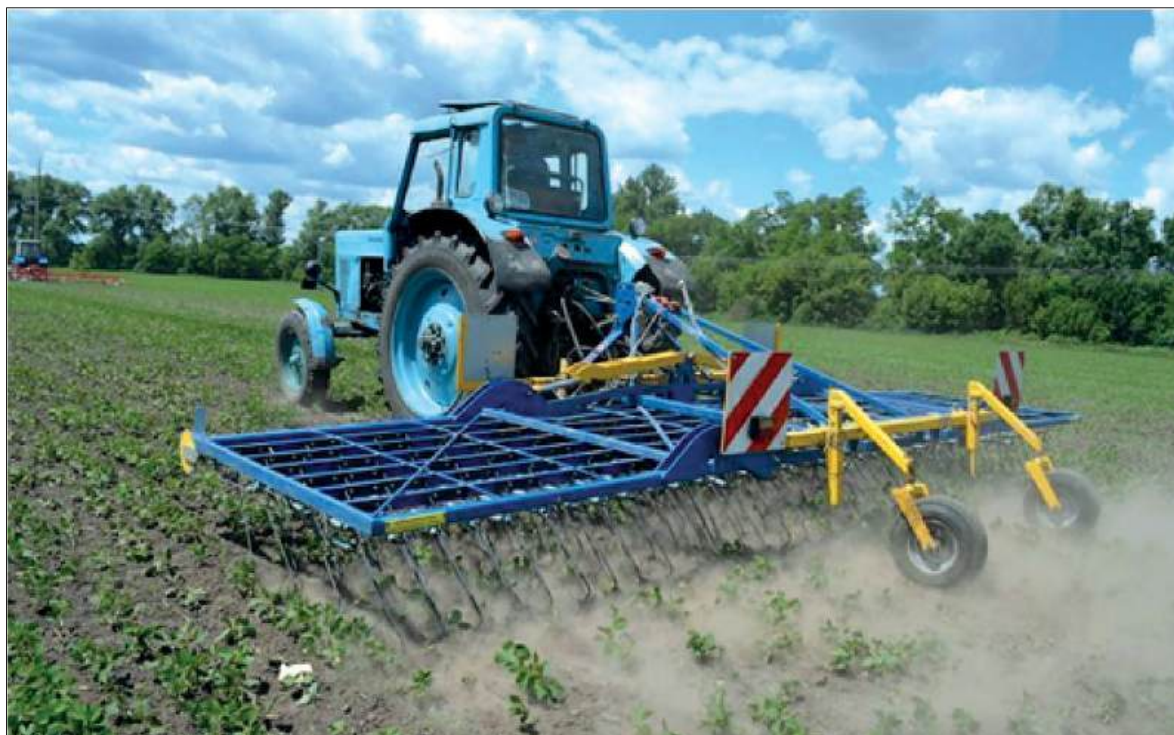
Рис. 8.15. Штригельна борона в післясходовому обробітку.
