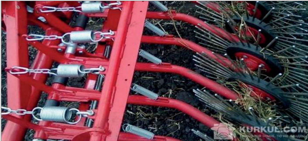
Рис. 9.10. Ротаційна штригельна борона AEROSTAR-ROTATION
