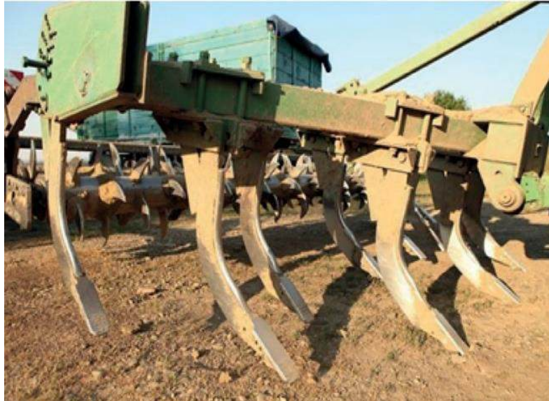
Рис. 8.13. Глибокорозпушувач Great Plains
