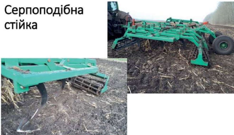
Рис. 9.11. Культиватор суцільного обробітку. Фото Г. Лук'яненка, 2020 р.
