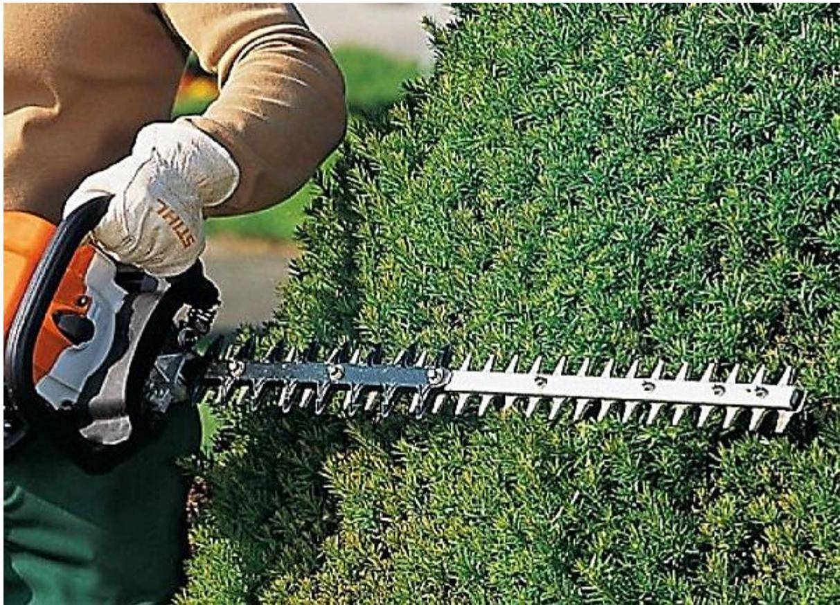
Рисунок 8.14 – Ручний моторизований інструмент для кронування кущів
