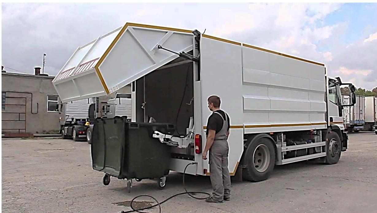
Рисунок 7.6 – Автомобіль для миття та дезінфекції контейнерів для сміття на шасі Iveco
