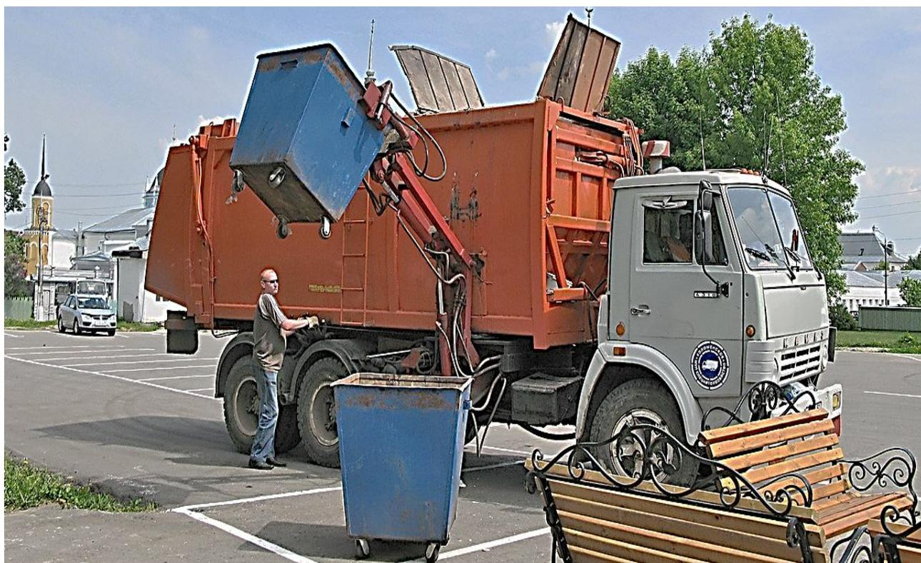
Рисунок 7.11 – Сміттевоз із боковим завантаженням
