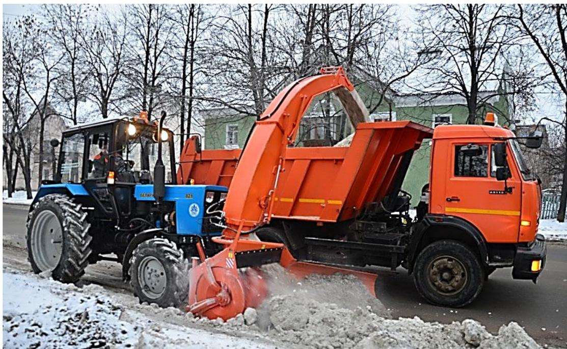
Рисунок 8.9 – Прибирання снігу роторним снігоочишувачем із завантаженням в самоскид
