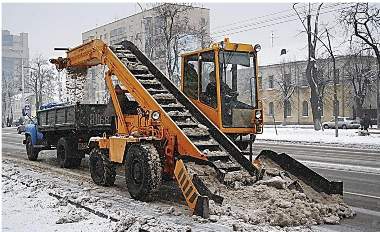
Рисунок 8.11 – Снігоавантажувач із живильником лапового типу
