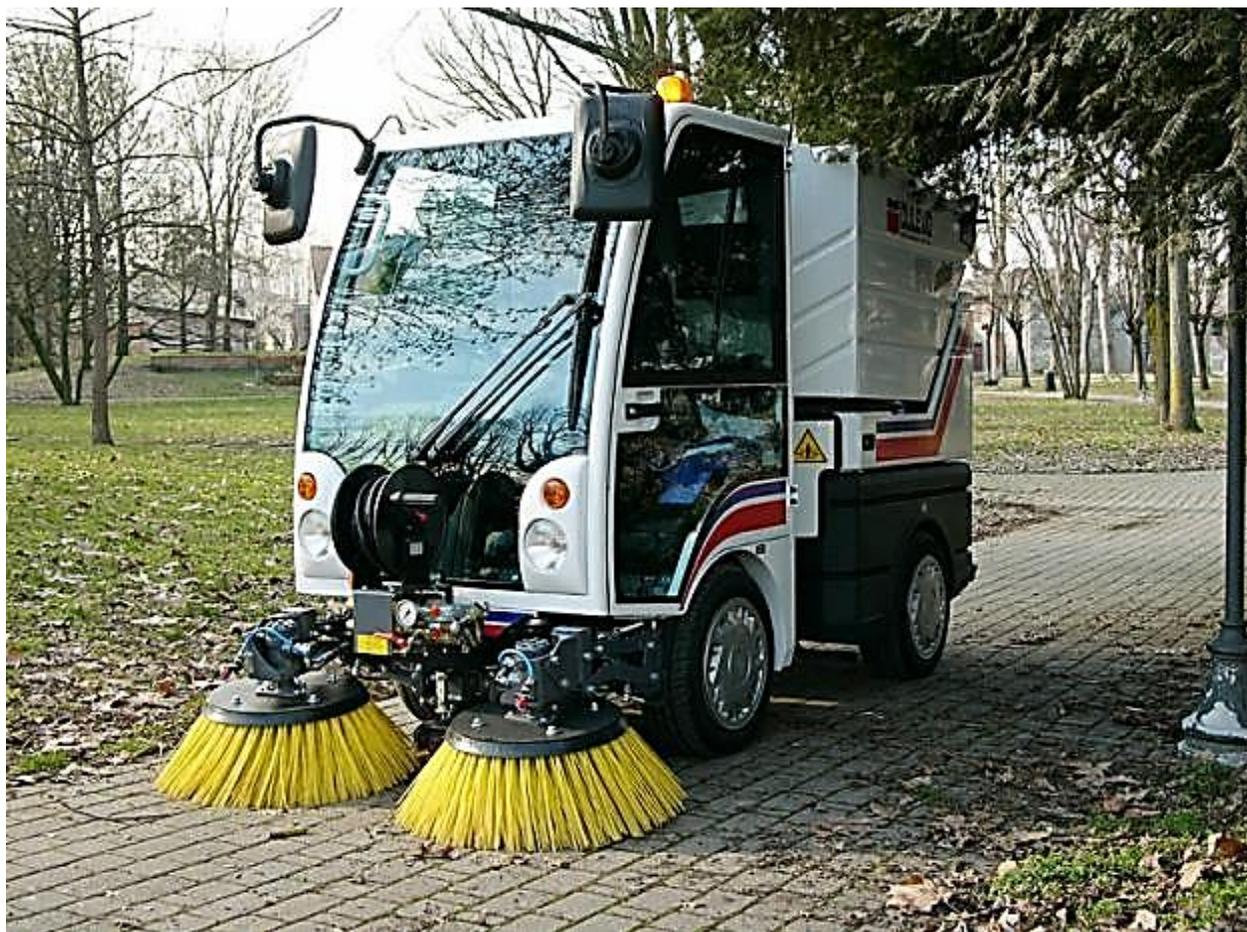
Рисунок 8.5 – Підмітально-прибиральна машина
