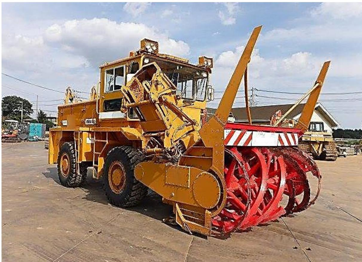
Рисунок 8.12 – Сніговантажувач із робочим органом фрезерного типу
