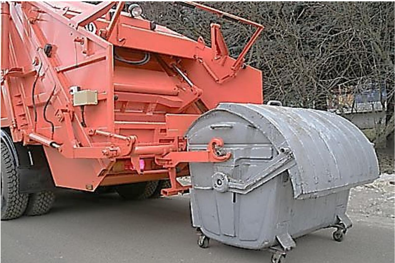
Рисунок 7.10 – Сміттєвоз із заднім завантаженням
