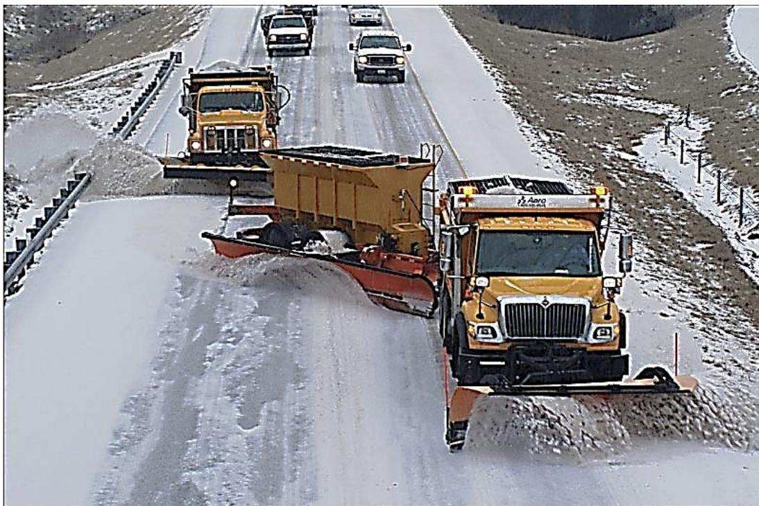
Рисунок 8.8 – Автомобілі, оснащені плужними снігоочисниками
