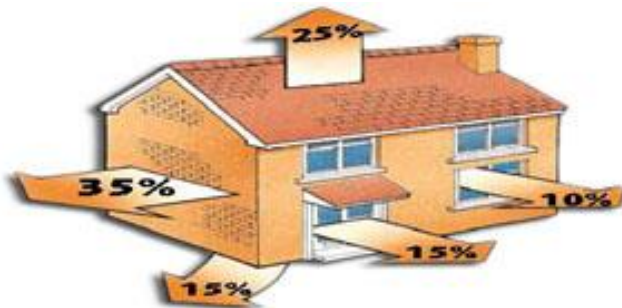
Рис.3 Втрати будівлею тепла
