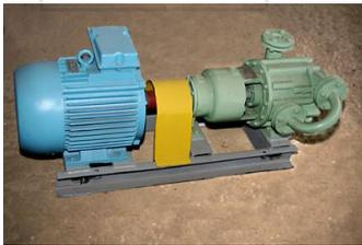
**Рис. 7.5. Зовнішній вигляд фекальних насосів типу ФГ**
