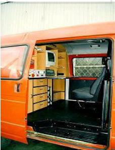
Рис. 5.1. Фрагмент пересувної лабораторії на базі автомобіля «Газель»
