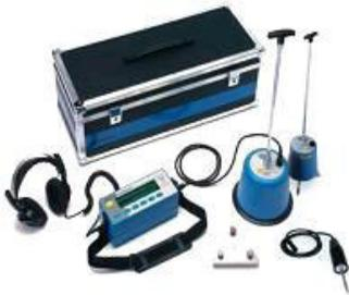
**Рис. 5.3.** Професійний прилад для виявлення місця витoku HL 5000
