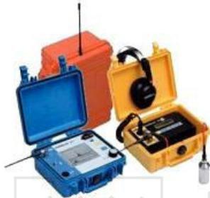
**Рис. 5.2.** Цифровий корелятор Correlux P1 для локалізації місць витoku в трубопроводах
