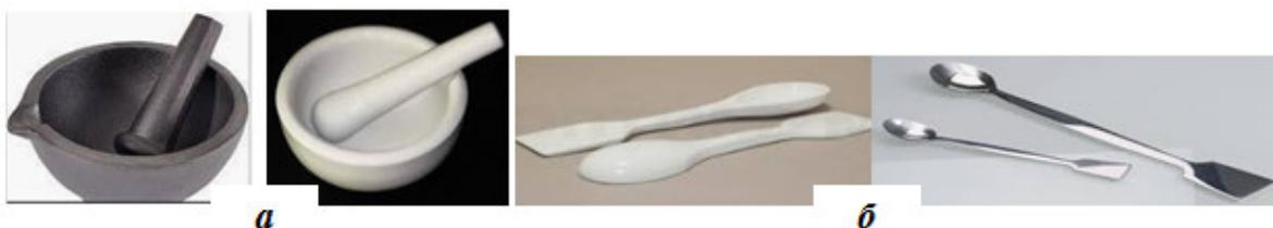
**Рис. 17 – Ступки з пестиками і шпатель для роботи з твердими зразками**
