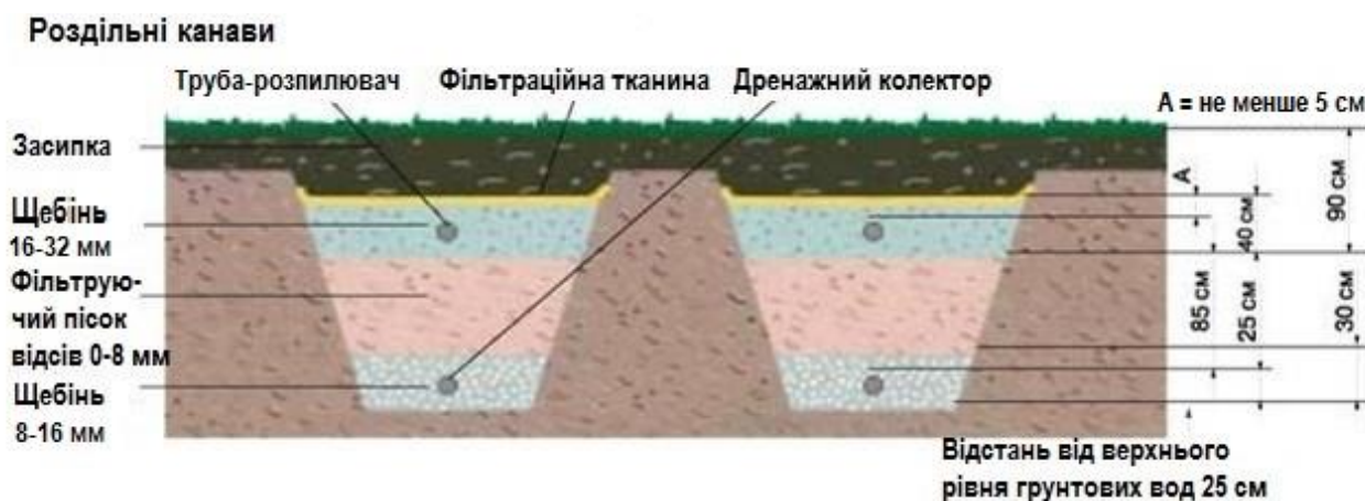
Рис. 9.2 – Схема поля підземної фільтрації з роздільними каналами
