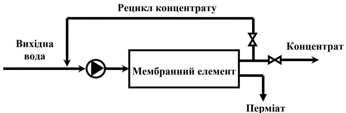
Рис. 7.14 – Принципова схема системи зворотного осмосу і нанофільтрації з рециклом концентрату
